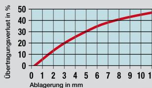
Auswirkung von Kalkablagerungen auf die Energie-Übertragung von Wärmetauschern. Ein Kalkbelag von nur 3 mm auf einem Heizelement verursacht bereits einen Wärmeübertragungsverlust von mehr als 20 %.
